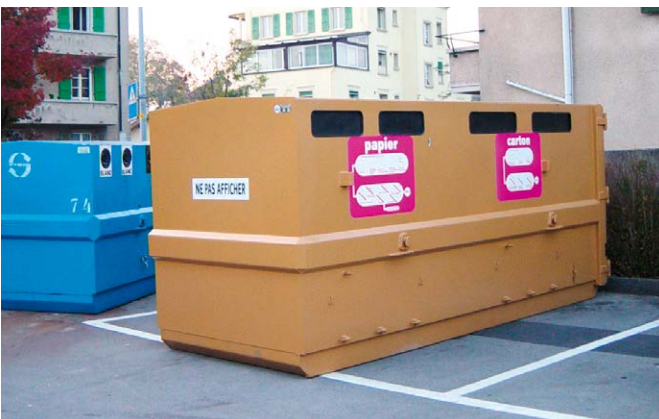
Système de bennes compartimentées pour le verre et le papier/carton permettant les échanges de bennes
