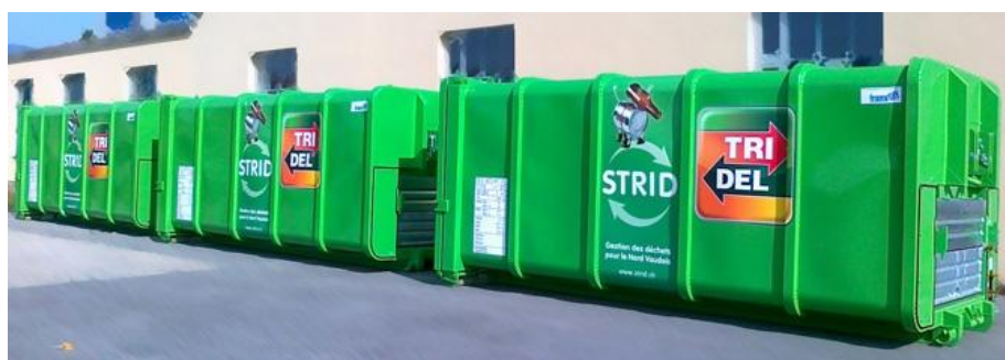
Bennes utilisées pour la collecte et le transfert par le rail des ordures ménagères.
